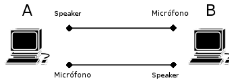
Figura 4. Conexión directa entre PCs (cruzado)
